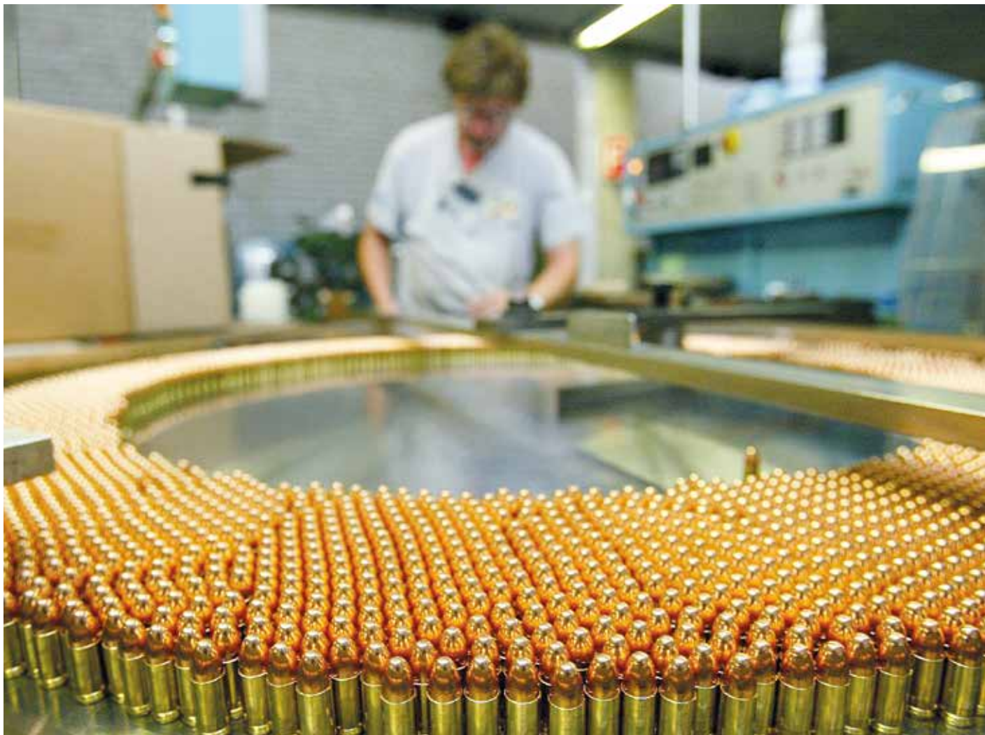
Controllo delle cartucce da 9 millimetri al dipartimento delle munizioni della Ruag.
