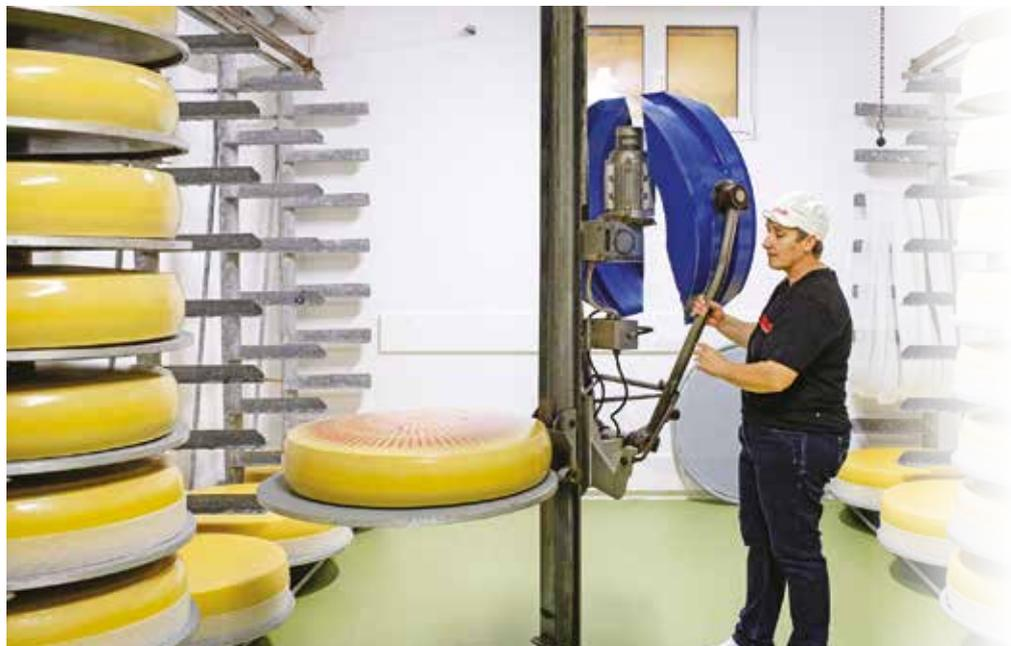
**Le grandi forme, che pesano spesso più di 100 kg, vengono girate regolarmente attraverso una macchina. Ma numerosi lavori sono ancora effettuati a mano.**
