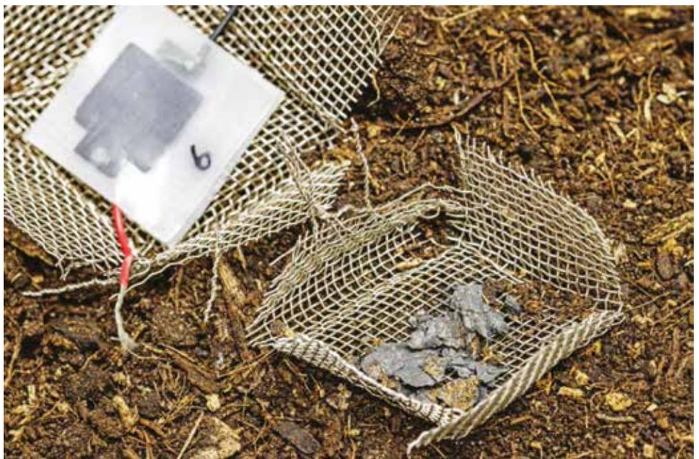
**Un compostaggio di successo: dopo due mesi nel terreno, il condensatore, anch'esso prodotto dall'Empa, si è disintegrato. Rimangono solo poche particelle di carbonio. La nuova batteria di carta si comporta esattamente nello stesso modo.**
