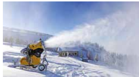
I cannoni da neve possono essere utilizzati solo quando la temperatura scende al di sotto di 0°C.
